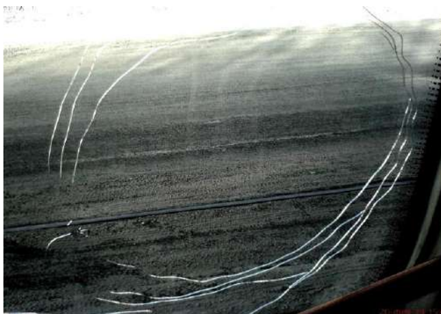
Рис. 4. Фотография силового хрупкого разрушения стекла транспортного средства от удара камня. Импульс динамического удара создает дополнительную энергию разрушения
