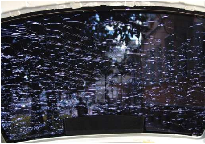
Рис. 2. Фотографии энергетического хрупкого разрушения автомобильных стекол (экспертиза). По сетке трещин можно утверждать о большой потенциальной энергии, освободившейся при образовании новых поверхностей трещин
