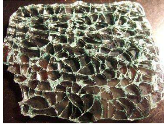
Рис. 2. Фотографии энергетического хрупкого разрушения автомобильных стекол (экспертиза). По сетке трещин можно утверждать о большой потенциальной энергии, освободившейся при образовании новых поверхностей трещин
