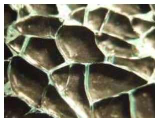
Рис. 5. Хрупкое разрушение автомобильного стекла: а) структура тридимита; б) гранулы при разрушении
